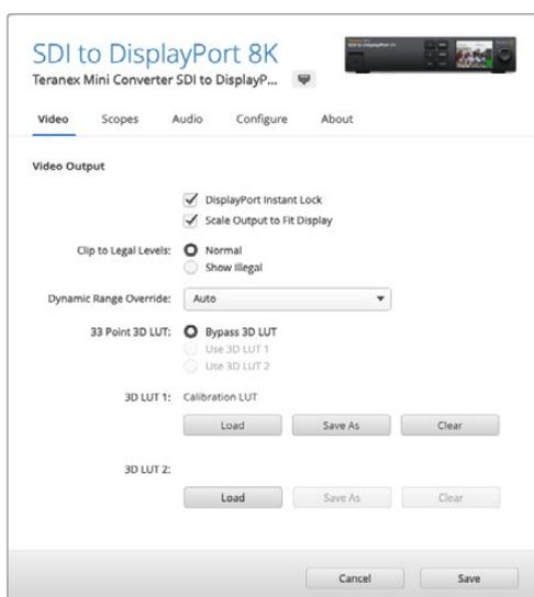
La LUT 3D du calibrage du moniteur est toujours assignée à **3D LUT 1** par défaut.
