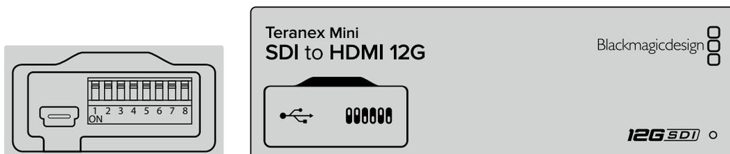
Réglez les paramètres en changeant la position des interrupteurs avec un stylo.
