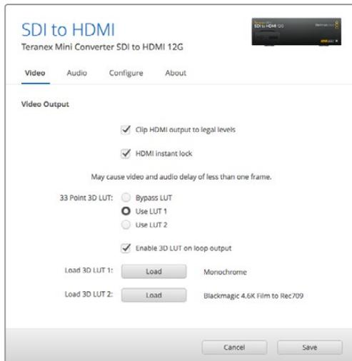
Le Blackmagic Teranex Setup vous permet de régler les paramètres suivants : HDMI Instant lock pour synchroniser instantanément le signal vidéo pendant le changement ou le routage des sources ; charger les LUTs 3D ; modifier les niveaux de sortie de l'audio analogique XLR et autres.
