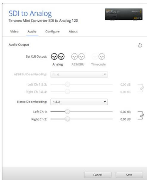
Ajustez les niveaux audio analogique et AES/EBU à l'aide de la page Audio du Blackmagic Teranex Setup.
