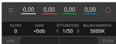
Posiziona il mouse sopra le impostazioni di gain, velocità dell'otturatore e bilanciamento del bianco e usa le frecce laterali per modificarle
