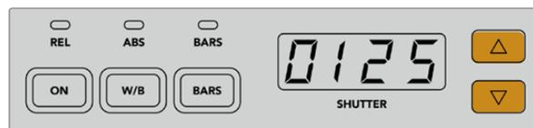
Premi le frecce accanto al display SHUTTER per regolare la velocità dell'otturatore
