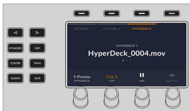
Ruota le manopole sotto le voci **HYPERDECK**, **CLIP**, **JOG** e **SHUTTLE** per selezionare il deck e la clip, e spostarti al suo interno alla velocità desiderata.
