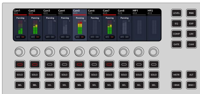
Il display LCD si aggiorna non appena selezioni una modalità con i pulsanti a destra delle strisce di canale. Per esempio se selezioni EQ, il display LCD visualizza i filtri medio-alti e alti, e i pulsanti e le manopole permettono di controllare i diversi parametri dell'equalizzatore.
