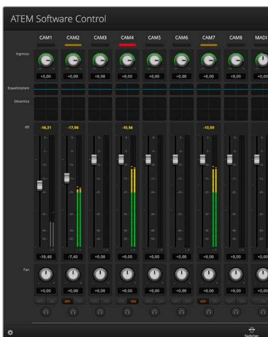
L'indicatore di livello della fonte Cam 1 è grigio perché l'audio è stato disabilitato, disattivando i pulsanti ON e AFV. Cam 2: il pulsante AFV è selezionato ma l'audio non è attivo perché la camera non è in onda, come indicato dalla luce tally gialla. Cam4 e Cam7: l'audio viene utilizzato (ON acceso) e le spie tally rimangono sempre accese anche se in onda c'è un'altra camera. Cam3, Cam5, Cam6 e Cam8: audio assente.
