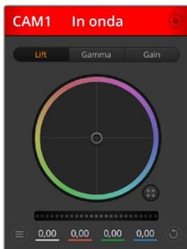
L'etichetta sopra ciascun controller indica se la camera è in onda. Usa le ruote di colore per regolare lift, gamma e gain di ogni canale YRGB.
