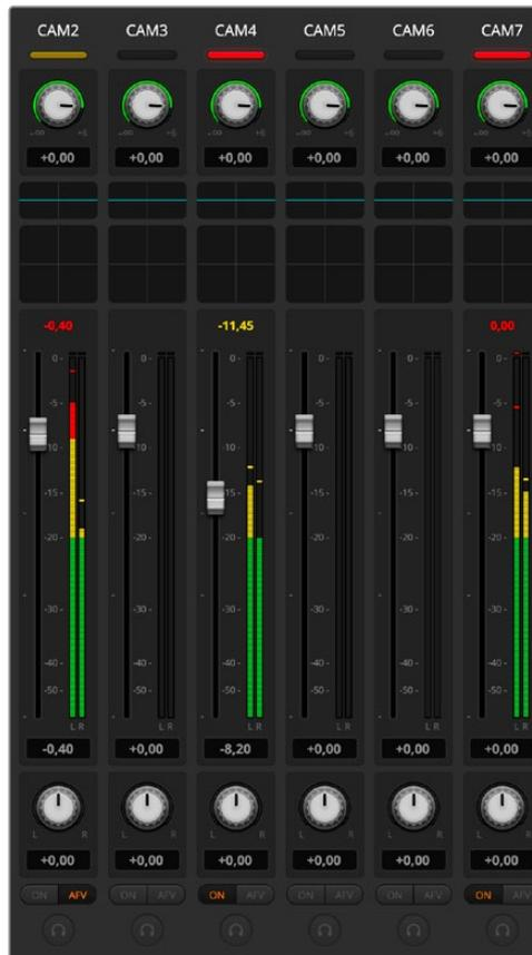
Alza e abbassa i fader della superficie di controllo e osserva l'interfaccia del mixer sul software per vedere se rispecchia correttamente i movimenti
