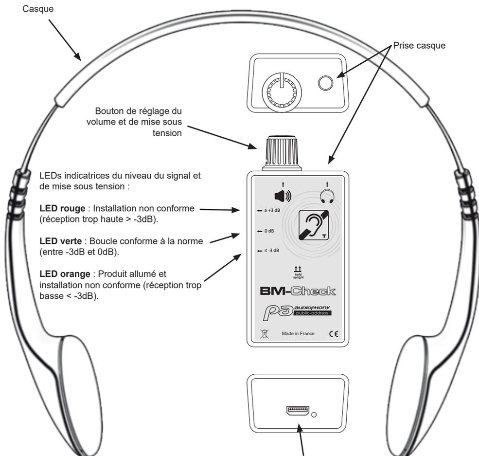
Note: Le BM-Check permet de faire une mise en service à la norme EN60118-4.
