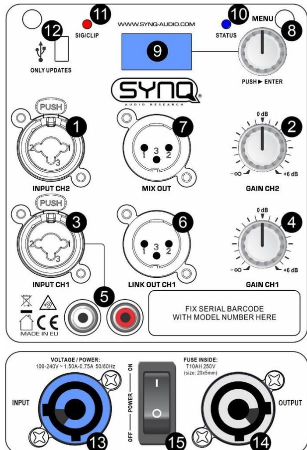
7. **MIX OUT:** Dieser symmetrische Ausgang (3pin-XLR) enthält das gemischte Signal der beiden Eingänge CH1 und CH2.
